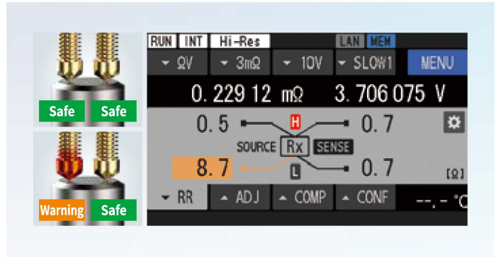
경로저항을 감시해 측정 에러가 나기 전에 경고를 표시
